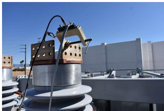
Подключение провода "Измерительный" к крупной сигнальной струбцине
