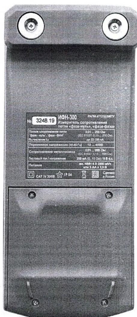
Рисунок 2 – Общий вид измерителей сопротивления петли «фаза-нуль», «фаза-фаза» ИФН-300. Вид сзади
