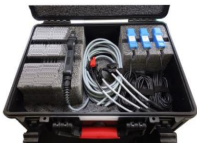
Комплект для теста первого срабатывания – трёхполюсное управление ONFTT-KIT-01
