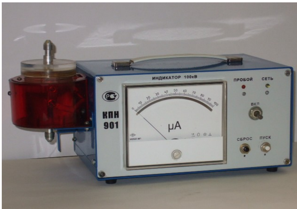
Рисунок 1 – Устройство контроля пробивного напряжения трансформаторного масла
