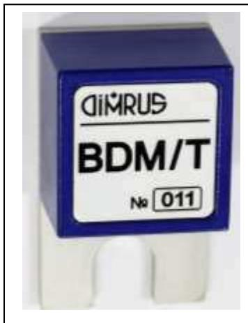
Минимальный переменный ток промышленной частоты, при котором датчик работает в непрерывном режиме, начинается со 100 ампер. При меньших рабочих токах датчик будет работать в периодическом режиме, включаясь по мере накопления энергии от внешнего поля во внутреннем конденсаторе.
