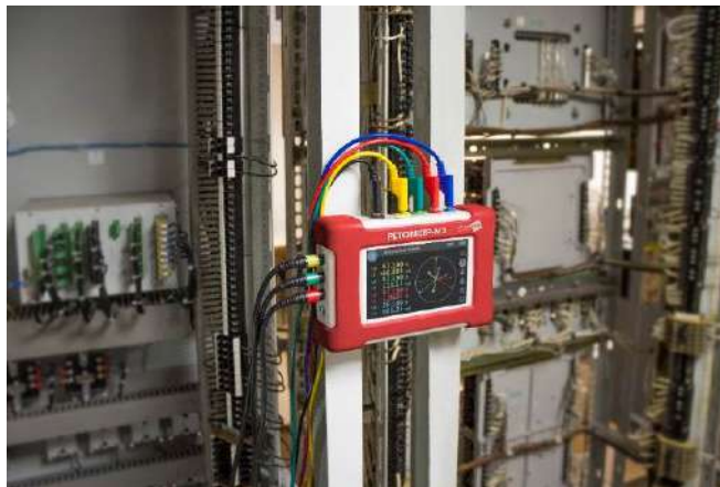
Рисунок 7.1 – Крепление вольтамперфазометра к металлической поверхности
