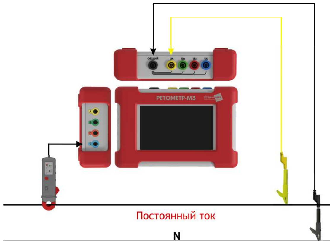
Рисунок Б.9 – Схема подключения при контроле параметров цепи постоянного тока
