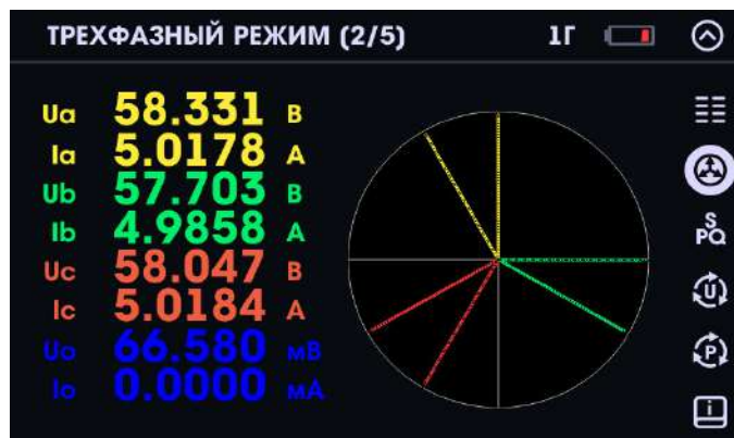
Рисунок Б.2 – Схема подключения к трехфазной сети «треугольником» и ее векторная диаграмма
