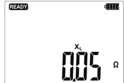
$X_L$  реактивное сопротивление петли короткого замыкания.
