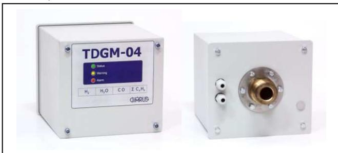
Для монтажа на баке трансформатора применяется конструкция газоанализатора в виде отдельного прибора, который монтируется на сливном кране бака трансформатора при помощи переходного фланца.
