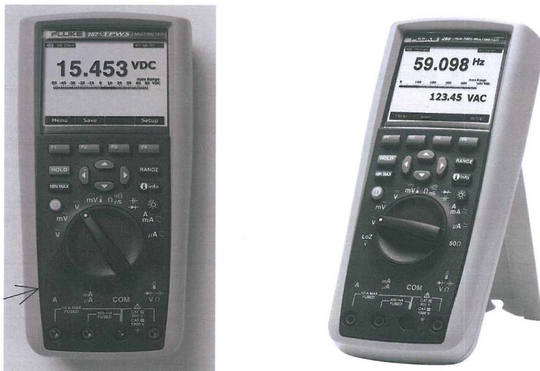
Рисунок 1 - Внешний вид мультиметра цифрового Fluke 287/289. Стрелкой показано место нанесения знака утверждения типа.
