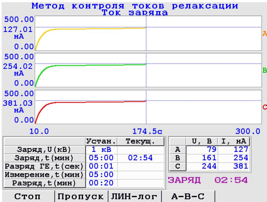
Рис. 3.31 Заряд «поляризационной» ёмкости объекта измерения
