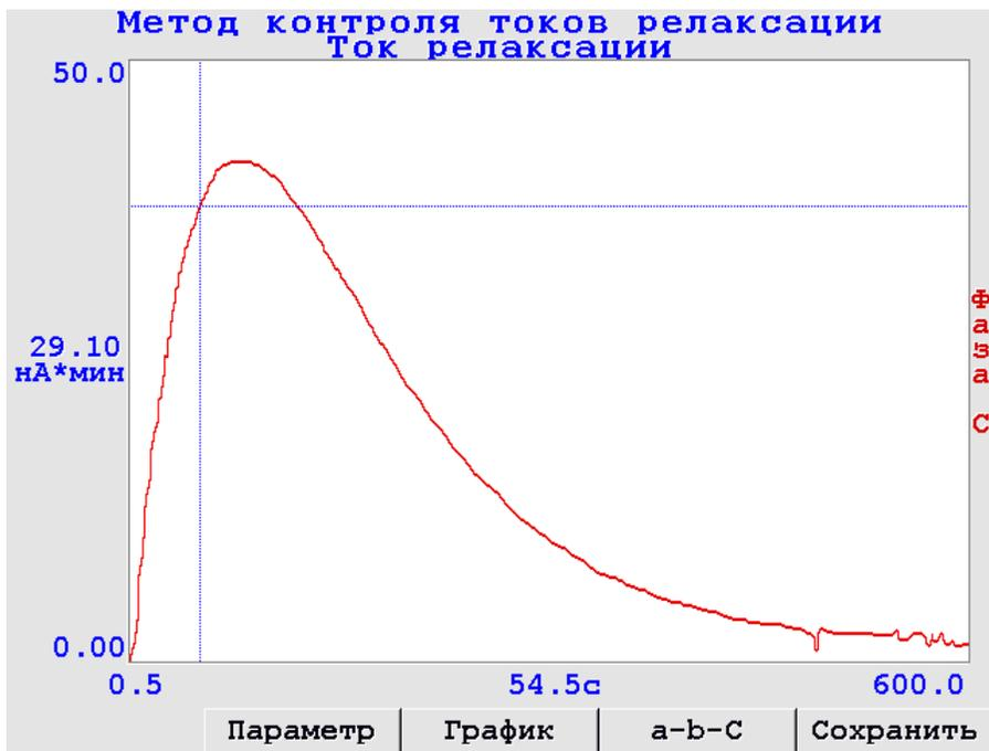
Рис. 3.34 Кривая изменения распределенного заряда в изоляции  $I^*t=f(t)$  фазы А
