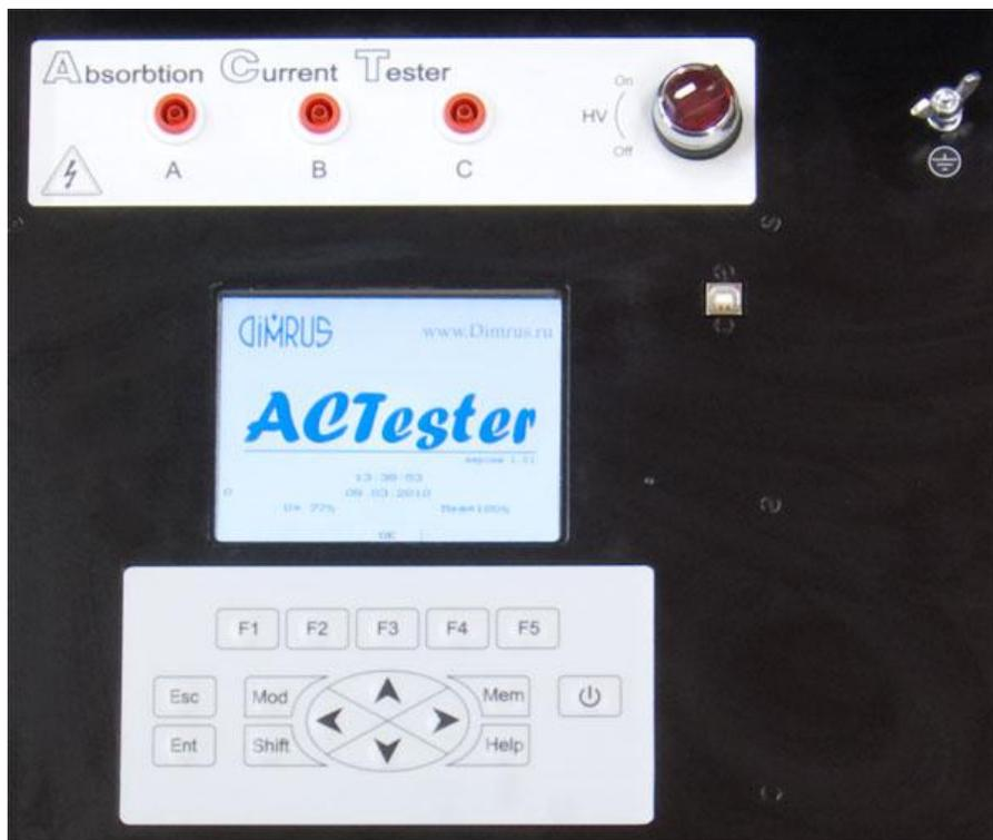
Рис. 2.1 Панель управления прибора AC-Tester
