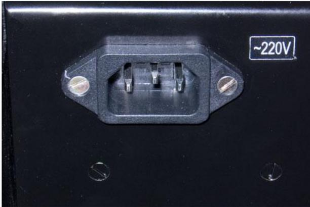
Рис. 2.2 Разъем для зарядного кабеля AC-Tester
