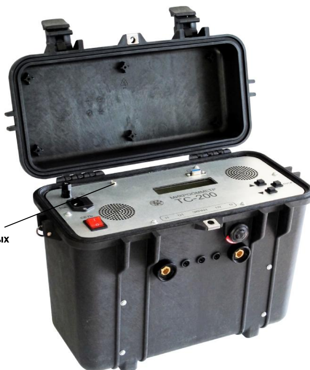
Рисунок 4 - Внешний вид микроомметра TC-200
