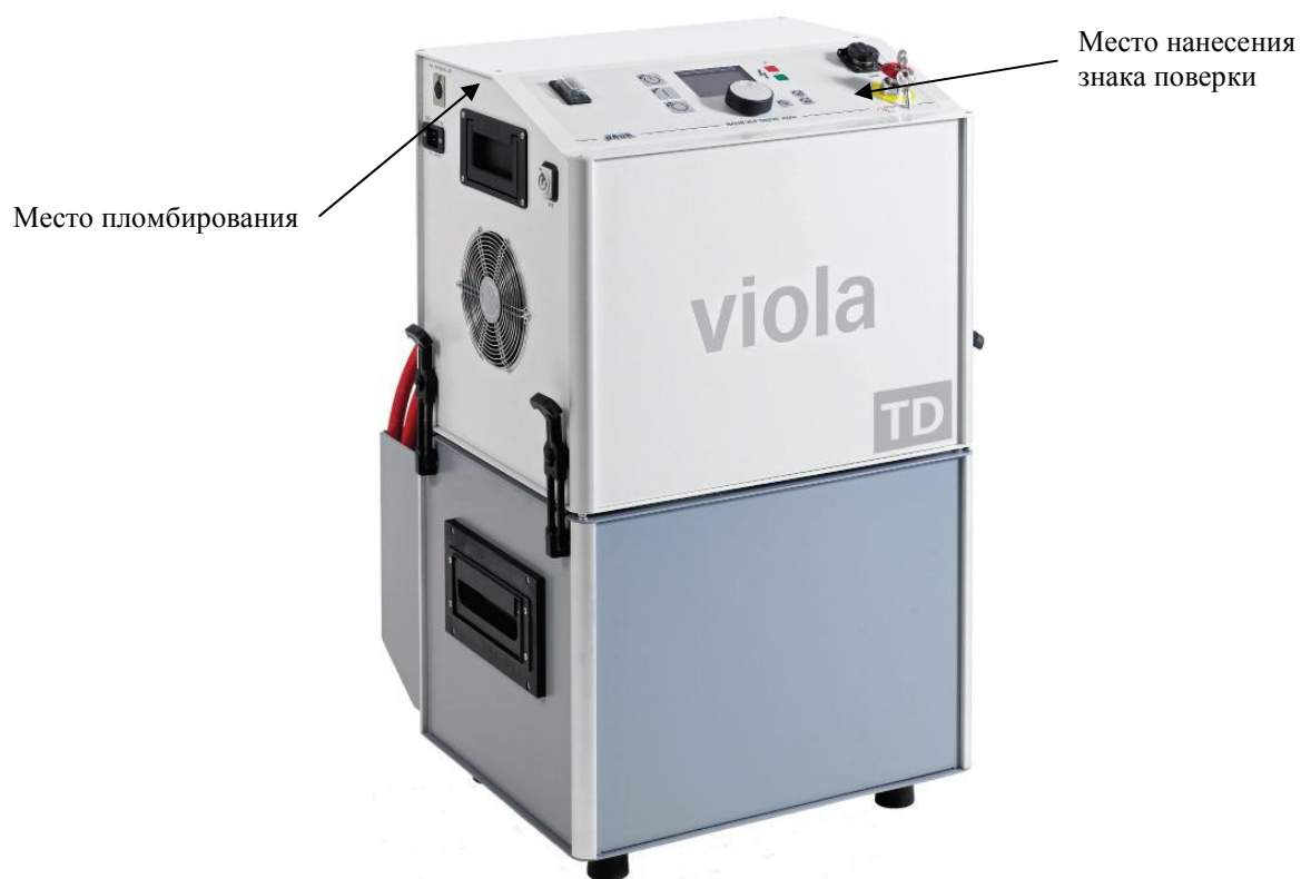
Рисунок 2 – Внешний вид генераторов высоковольтных инфранизкочастотных Viola TD
