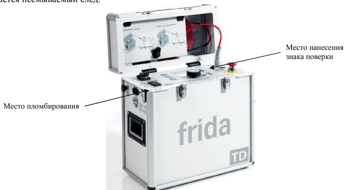
Рисунок 1 – Внешний вид генераторов высоковольтных инфранизкочастотных Frida TD
