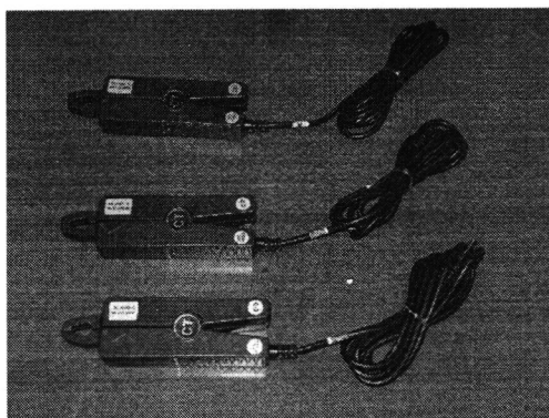
Рисунок 4 – Комплект измерения тока с токовыми клещами ТК-30АС-А (В, С) «/30АС»
