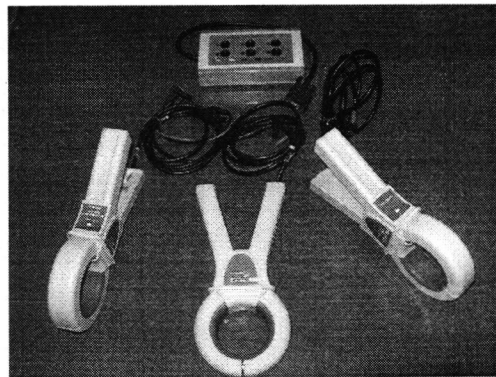
Рисунок 5 – Комплект измерения тока с токовыми клещами ТК-800АС-А (В, С) «/800АС»
