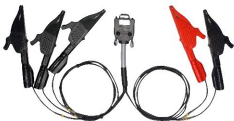
**Измерительный кабель для CVM-4 с разъёмами "банан" + зажимы "дельфин"**
