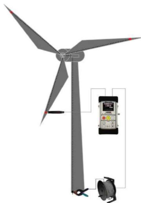
Испытание грозозащитной системы с RMO-ЕН
