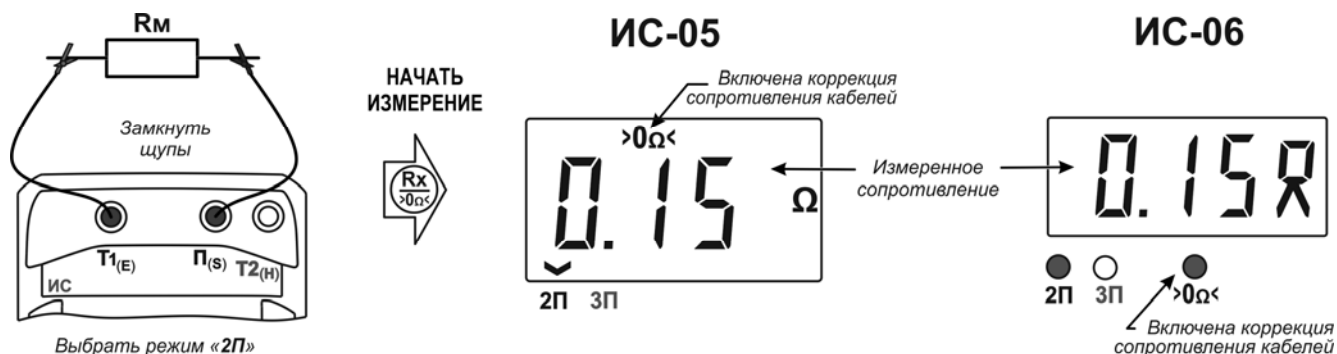
Рисунок 6 – Схема подключения и вид индикатора при двухпроводном методе измерения
