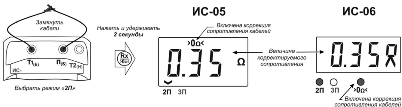
Рисунок 4 – Коррекция сопротивления измерительных кабелей (2П)
