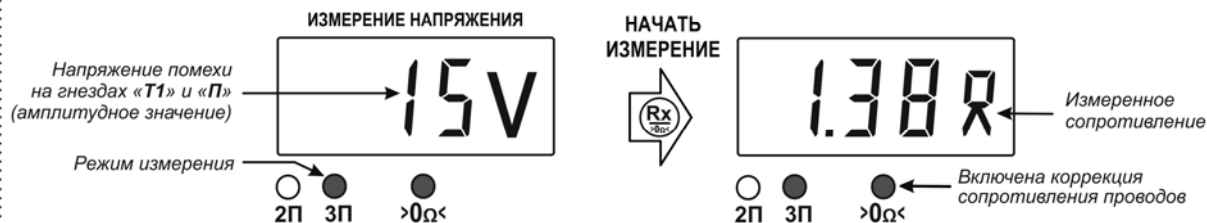
Рисунок 5 - Схема подключения и вид индикатора при измерении сопротивления заземления трёхпроводным методом
