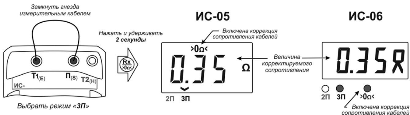
Рисунок 3 – Коррекция сопротивления измерительного кабеля (3П)
