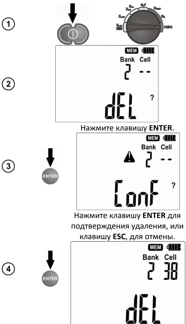
Включите измеритель. Установите поворотный переключатель в положение **MEM**.
