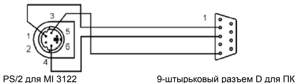
Рисунок 6.12: Подключение для передачи данных посредством COM – порта ПК
