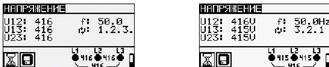
Рисунок 5.17: Примеры измерения напряжения в трехфазной цепи
