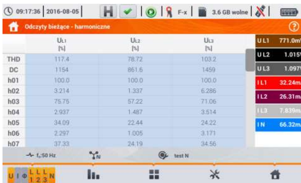
Рис. 6.18. Текущие показания – гармоники – табличный вид
