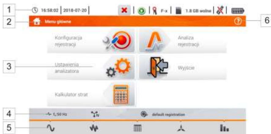
Рис. 6.2 Основные элементы экрана регистратора
