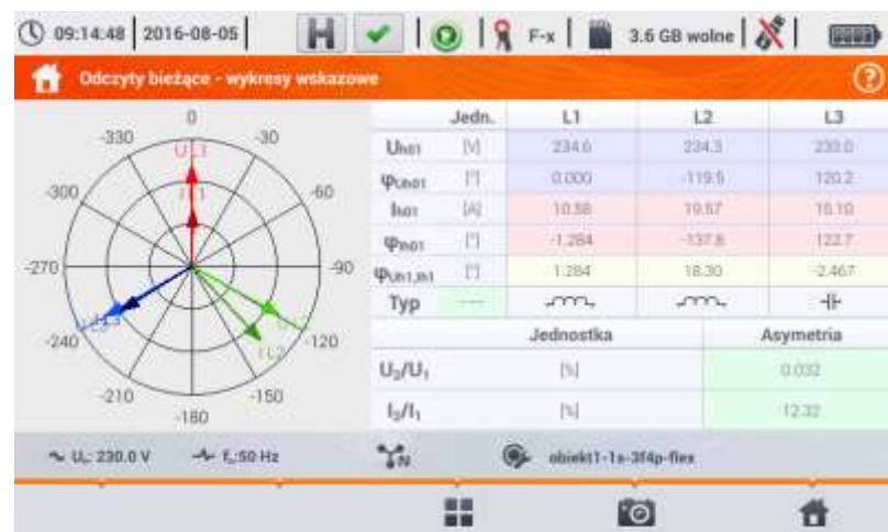
Рис. 6.16. Текущие показания – векторная диаграмма
