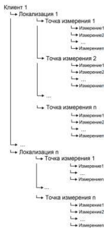
Рис. 7.1. Структура памяти измерителя для отдельного клиента
