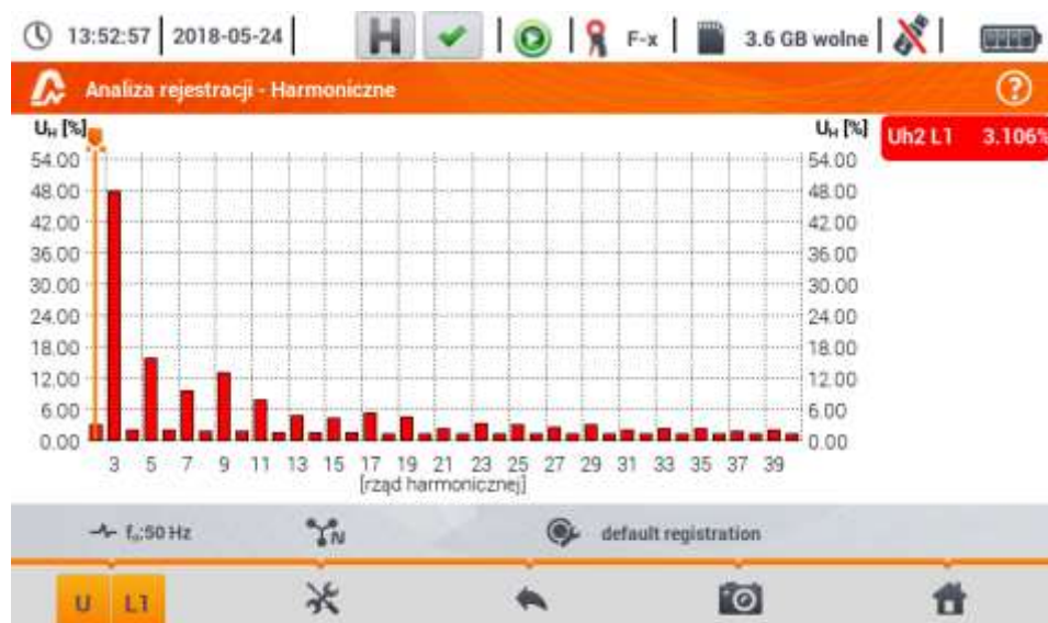
Рис. 6.23. Текущие показания – представление гармоник в виде гистограммы
