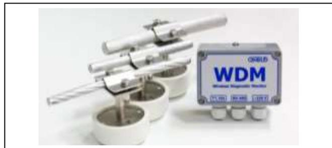
Беспроводные датчики контроля температуры проводов линии монтируются непосредственно на проводах. Информация о текущей температуре проводов передается от всех датчиков WTS в систему DiLin при помощи приемника марки WDM, подключенного к системе по проводному гальванически изолированному интерфейсу RS-485.
