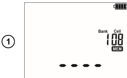
После выполнения измерения нажмите клавишу **ENTER**, прибор переходит в режим записи в память.
