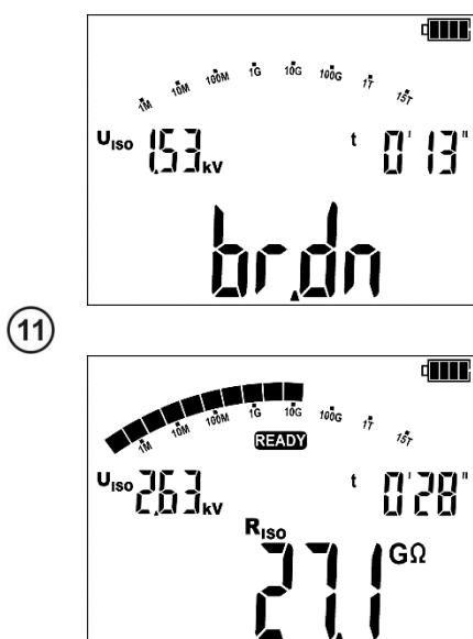
Если в процессе нарастания напряжения произойдет пробой изоляции, то измеритель отобразит:
