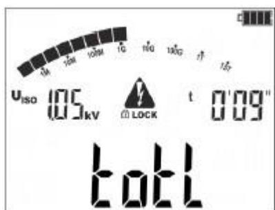
При первом этапе измеряется суммарное сопротивление изолятора  $R_{totl}$ .
