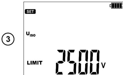
Окончательное напряжение измерения **U<sub>Iso</sub> LIMIT**.
