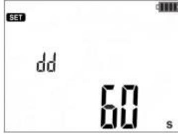
Настройка времени измерения тока утечки для функции **DD**.
