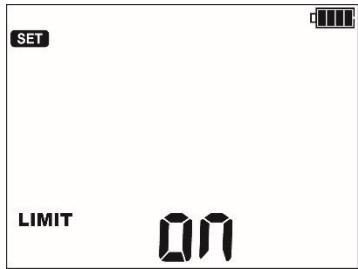
Включение (**ON**) и выключение (**OFF**) установки лимитов. Для состояния **ON** появляются новые параметры для настройки.
