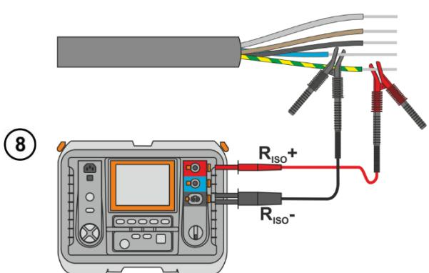
Подключите измерительные провода согласно рисунку.
