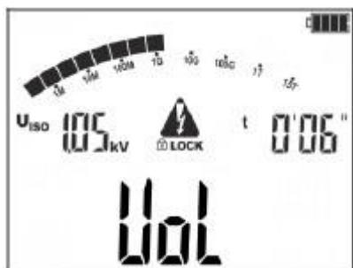
На втором этапе измеряется поперечное сопротивление  $R_{vol}$ .
