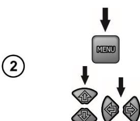
Нажимая клавишу  **MENU** можно перейти к выбору времени для расчёта коэффициентов абсорбции ( $t_1$ ,  $t_2$ ,  $t_3$ ), общему времени измерения  $t_n$ , измерительного тока  $I_{SC}$  и лимитов.
