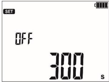
Время до автоматического выключения (300 сек., 600 сек., 900 сек.) или его отсутствие (---).
