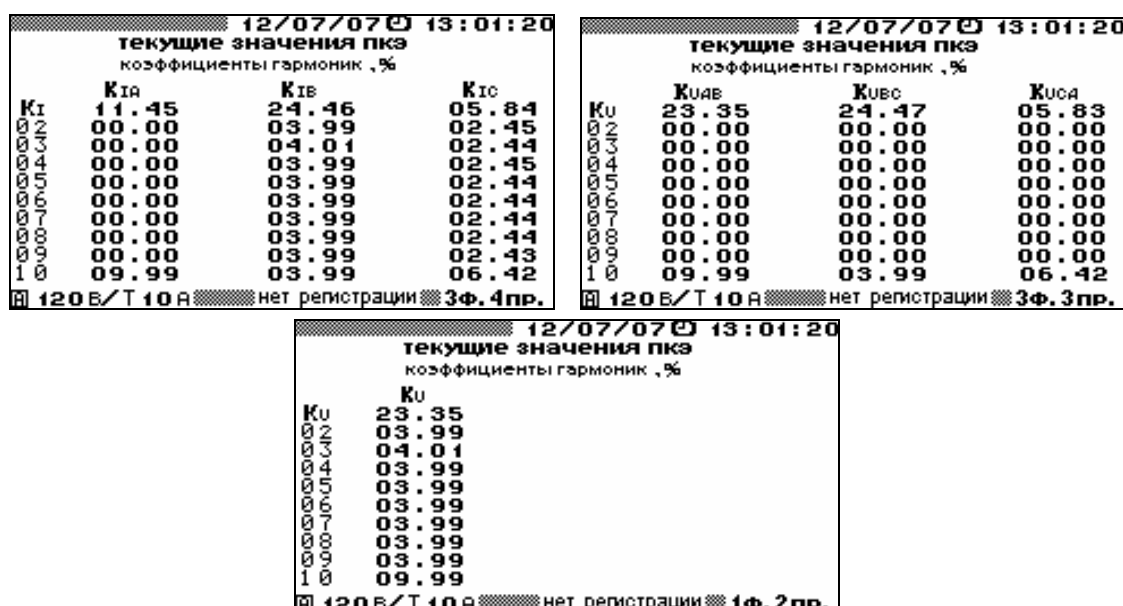
Рис. 4.24. Окна отображения коэффициентов искажения синусоидальности и гармонических составляющих напряжений и токов для различных схем включения
