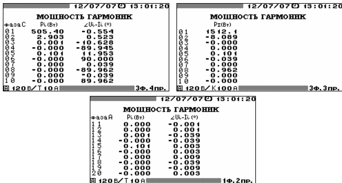
Рис. 4.12. Режим отображения гармонических составляющих активной мощности для различных схем включения
