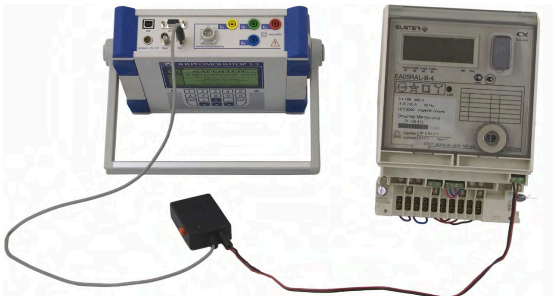
Рис. В.10. Схема подключения Прибора ЭМ-3.3Т1 к поверяемому счетчику с токовым импульсным выходом через ПФИ
