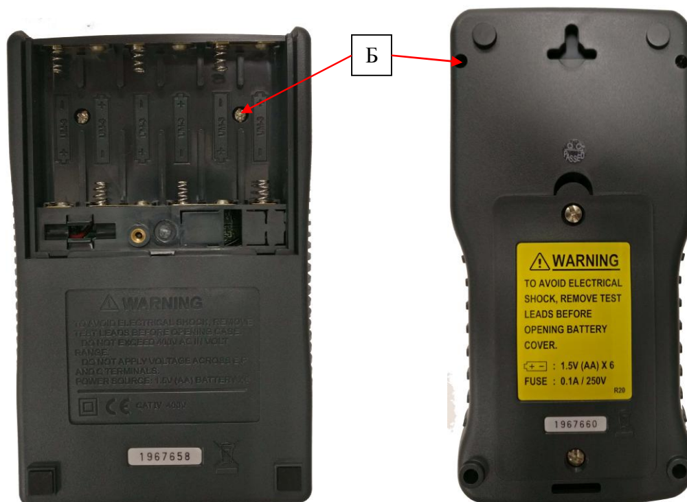
Рисунок 4 – Схема пломбировки модификаций 1620 ER и 8020 ER от несанкционированного доступа (Б)
