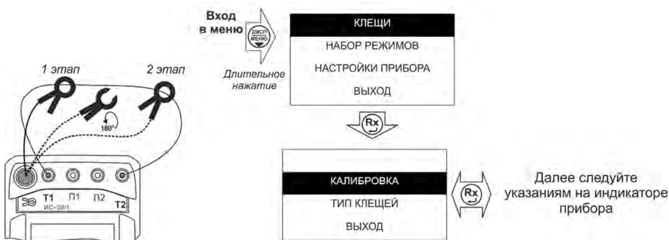
Рисунок 2.14 – Калибровка токоизмерительных клещей
