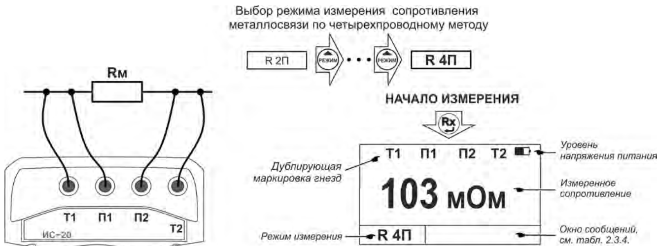
Рисунок 2.7 – Схема подключения и вид индикатора при четырехпроводном методе измерения
