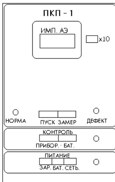
Рис.5. Передняя панель прибора ПКП-1
