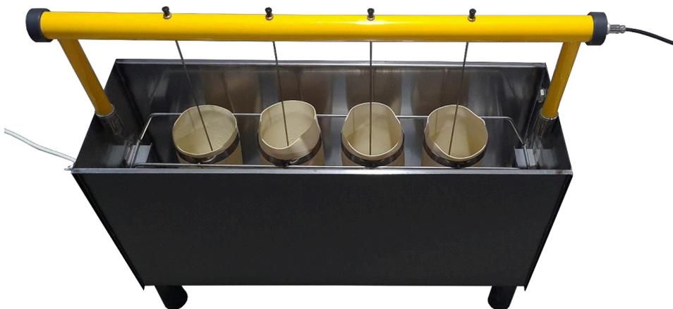
Рисунок 5 – Установка перчаток в ванну для испытания
