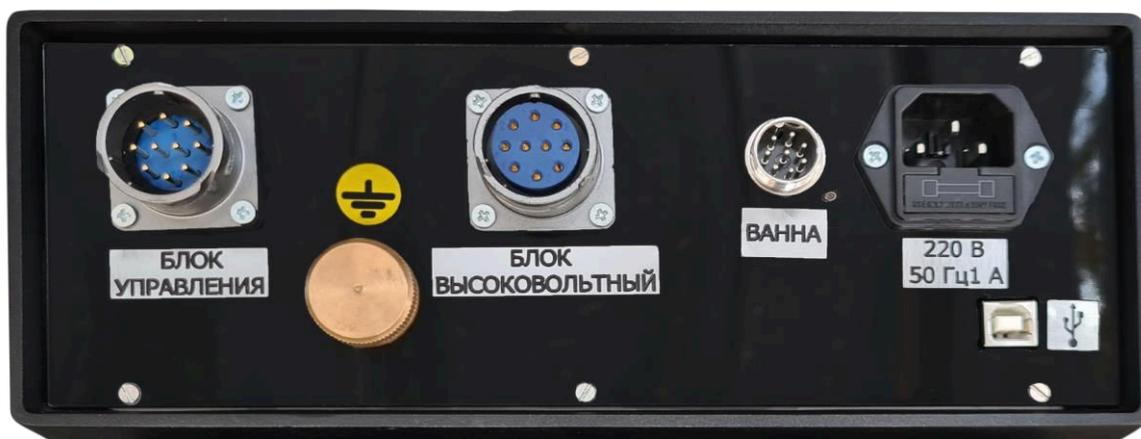
Рисунок 3 – Задняя панель блока измерительного приставки СКАТ-70П
