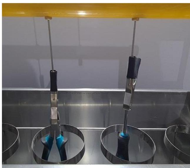
Рисунок 8 – Подключение электроинструмента при помощи зажимов типа «крокодил»
