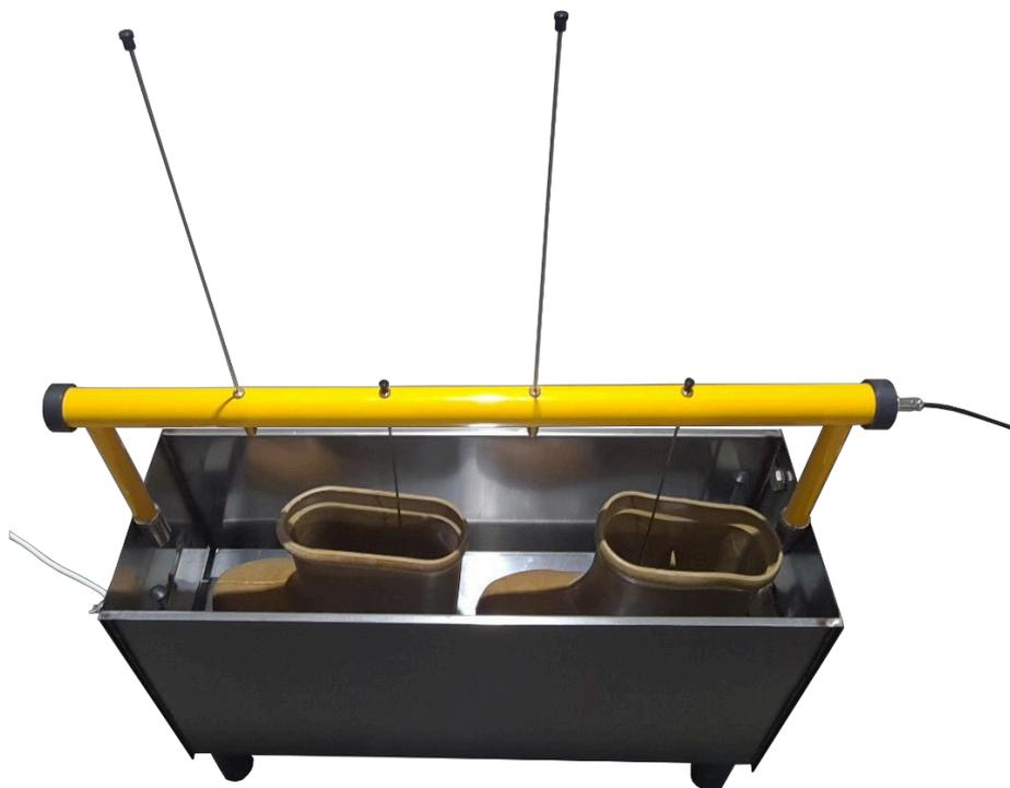
Рисунок 6 – Установка бот в ванну для испытания
