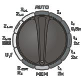
Включите измеритель. Установите поворотный переключатель в положение **MEM**.
