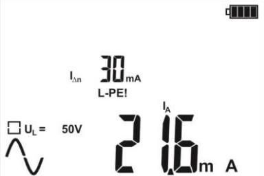
Главный результат измерения - ток отключения УЗО  $I_A$ .
