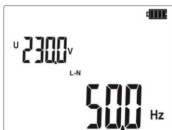
Результаты измерения: частота – на основной части экрана, напряжение - на вспомогательной.
