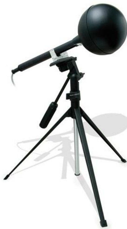
Шаровой термометр со штативом
