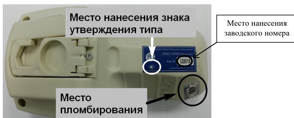
Рисунок 2 - Схема пломбировки от несанкционированного доступа и место нанесения знака утверждения типа
