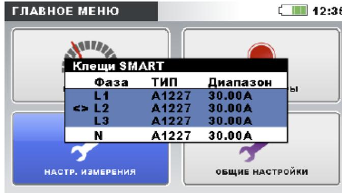
Рисунок 4.22: Состояние автоматически распознаваемых токовых клещей
