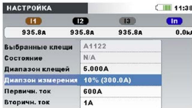
Рисунок 4.20: Выбор 10-процентного диапазона для токовых клещей
