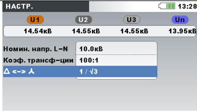
**Voltage ratio (коэфф. трансформации):** Коэффициент трансформации трансформатора напряжения  $\Delta \leftrightarrow \sqrt{3}$ :
