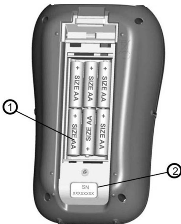
Рисунок 7.1: Батарейный отсек
