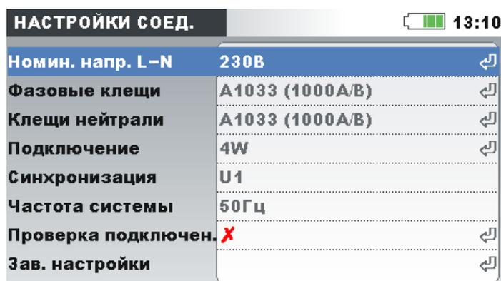
Рисунок 3.2: Экран «CONNECTION SETUP» (НАСТРОЙКА СОЕДИНЕНИЯ)
