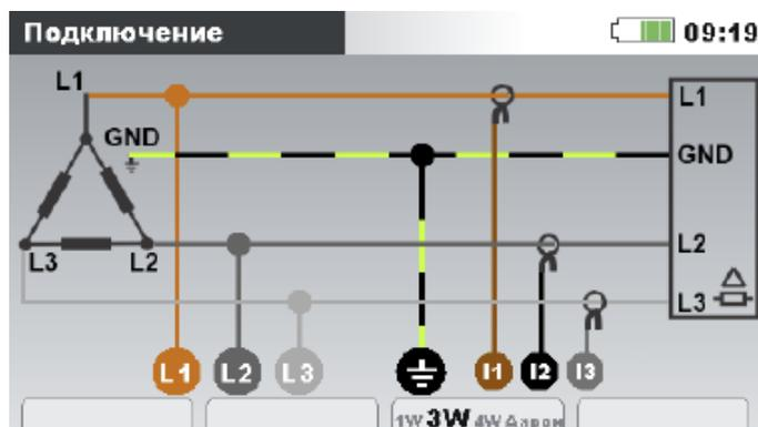
Рисунок 4.4: Выбор 3-фазной 3-проводной системы на приборе
