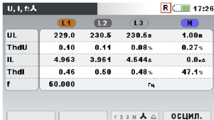
Рисунок 3.5: Экран прибора для измерения напряжения, тока и частоты (U, I, f) в вызванной копии экрана записи
