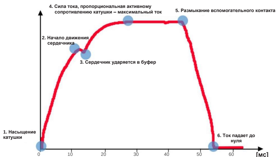
Рисунок 4. Типичная кривая силы тока катушки
