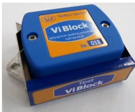
Рис. 3.3. Размещение настроечного магнита на приборе ViBlock (его необходимо снять после просмотра данных и окончания настроек).
