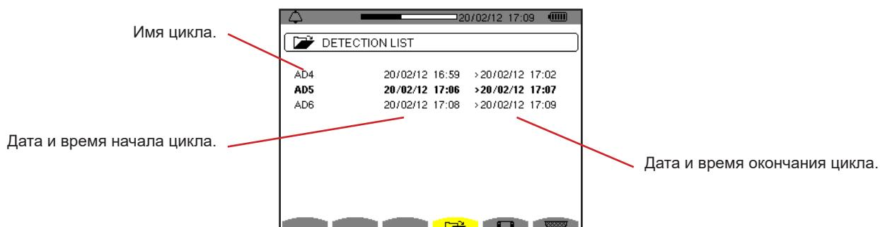
Рис. 86: экран индикации списка циклов
