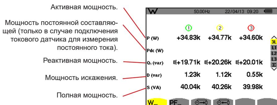
Рис. 109: экран индикации показателей мощности с фильтром 3L
