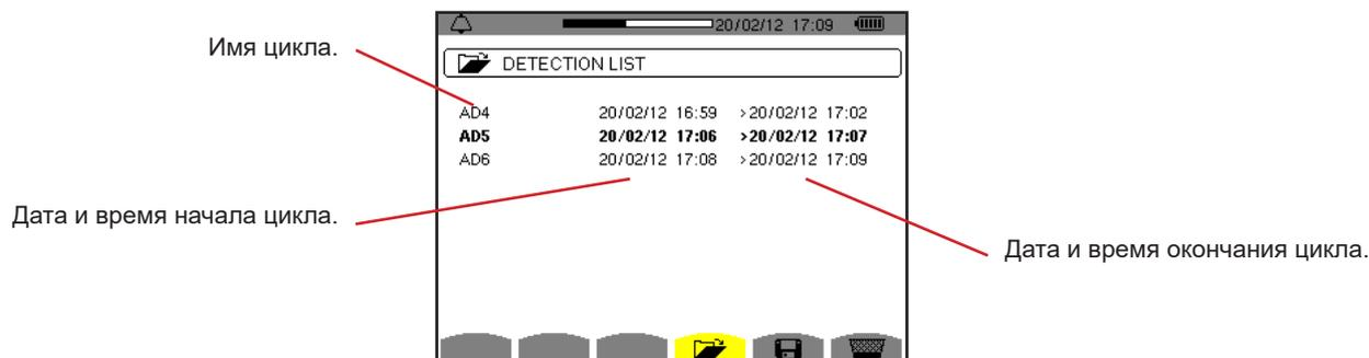
Рис. 86: экран индикации списка циклов
