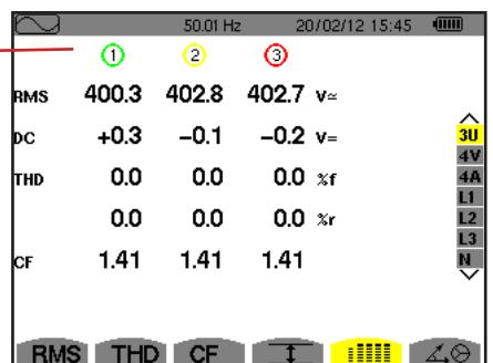
Рис. 78: экран одновременной индикации с фильтром 3U
