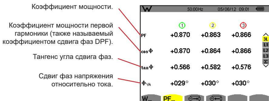
Рис. 110: экран индикации величин, связанных с мощностью, с фильтром 3L
