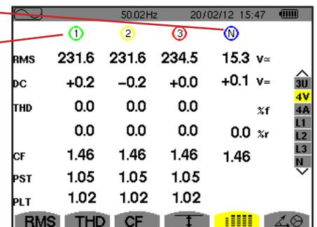
Рис. 79: экран одновременной индикации с фильтром 4V
