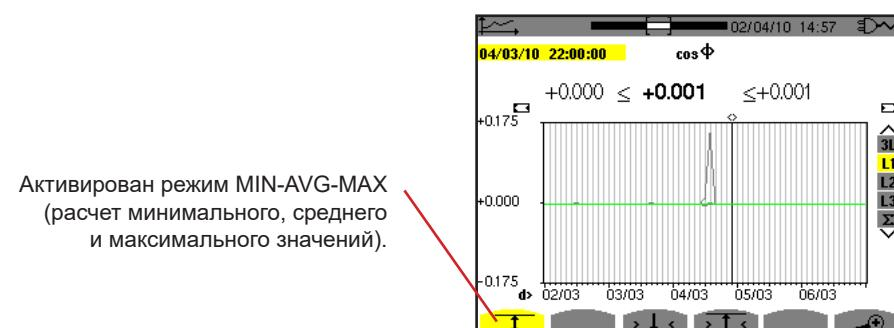
Рис. 104: параметр  $\cos \Phi (L1)$  в режиме MIN-AVG-MAX
