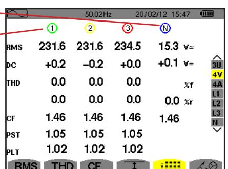
Рис. 79: экран одновременной индикации с фильтром 4V
