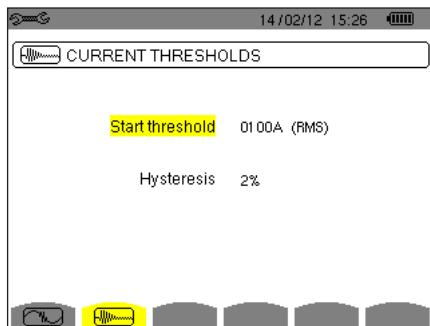
Рис. 30: экран «Пороговые значения тока» в меню «Режим пускового тока»
