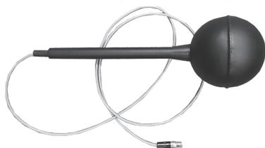
Рис. 3 Шаровой термометр
