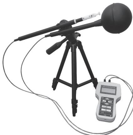
Рис.4. Измеритель параметров микроклимата в комплекте с шаровым термометром
