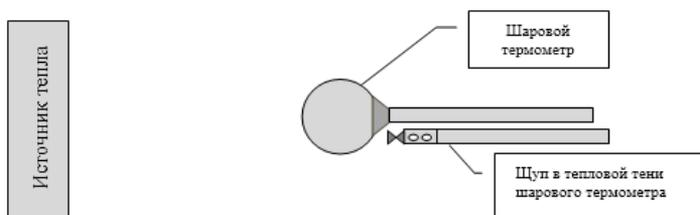
Рис.6 Относительное расположение измерительной аппаратуры и источника излучения.
