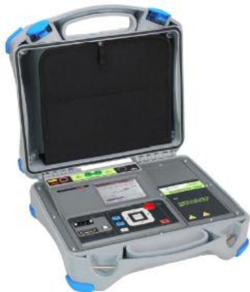
Тераомметры имеют несколько диапазонов установки выходного напряжения. Кроме этого приборы обладают возможностью пошагового (ступенчатого) и плавного изменения выходного напряжения, вычисления индекса поляризации (PI), коэффициента диэлектрического разряда (DD), емкости испытываемого объекта. Приборы имеют встроенный таймер.
