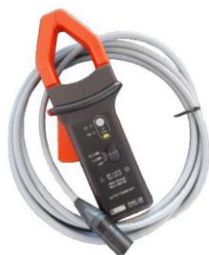
Токовые клещи 30/300 А, питаемые от прибора с кабелем 5 м
