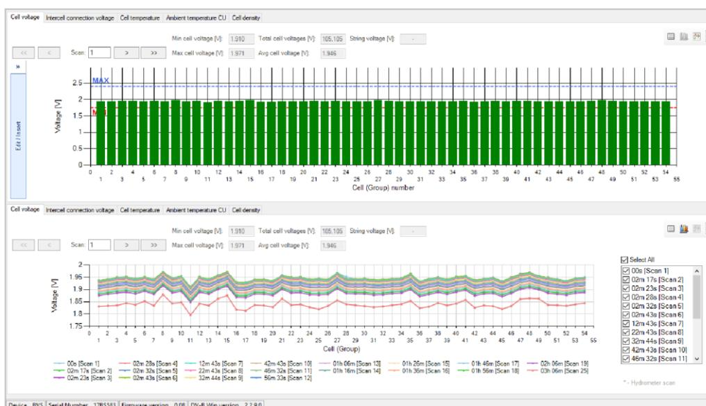
Функции приложения DV-B Win – Просмотр сканов и линейных графиков отдельных элементов
