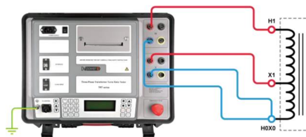
Подключение TRT к однофазному автотрансформатору
