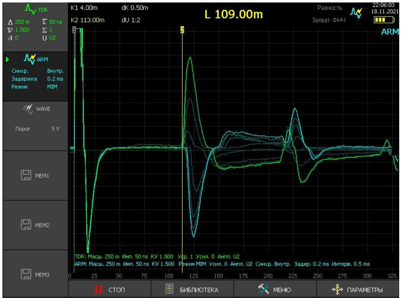
Рисунок 6.3 Сравнение рефлектограмм полученных в импульсном (зеленая) и в импульсном-дуговом ARM-MIM режиме (голубые)
