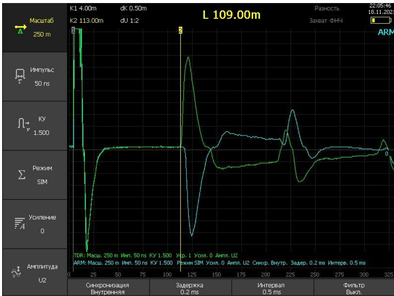
Рисунок 6.2 Сравнение рефлектограмм полученных в импульсном (зеленая) и в импульсном-дуговом режиме ARM-SIM (голубая)
