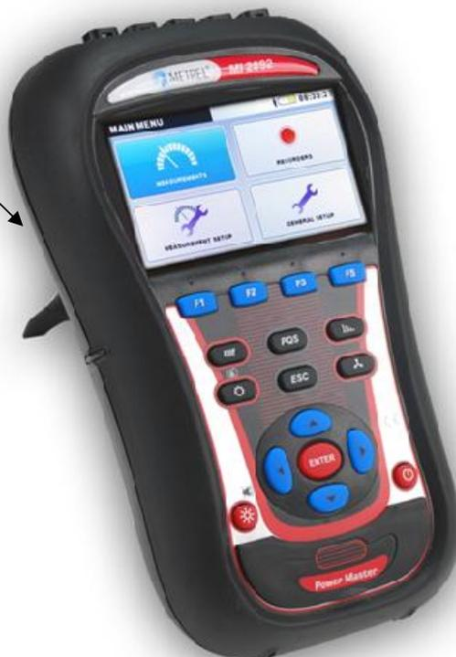
Рисунок 2 – Место нанесения пломбы завода-изготовителя
