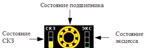
Рисунок 4 – Изображение на нижней части экрана прибора
