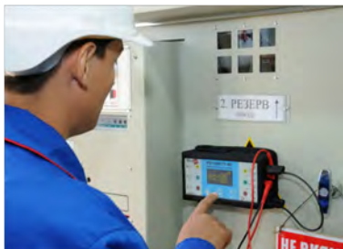
а) крепление прибора к металлической поверхности
