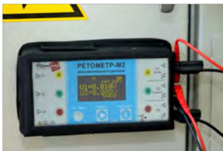
а) крепление прибора к металлической поверхности
