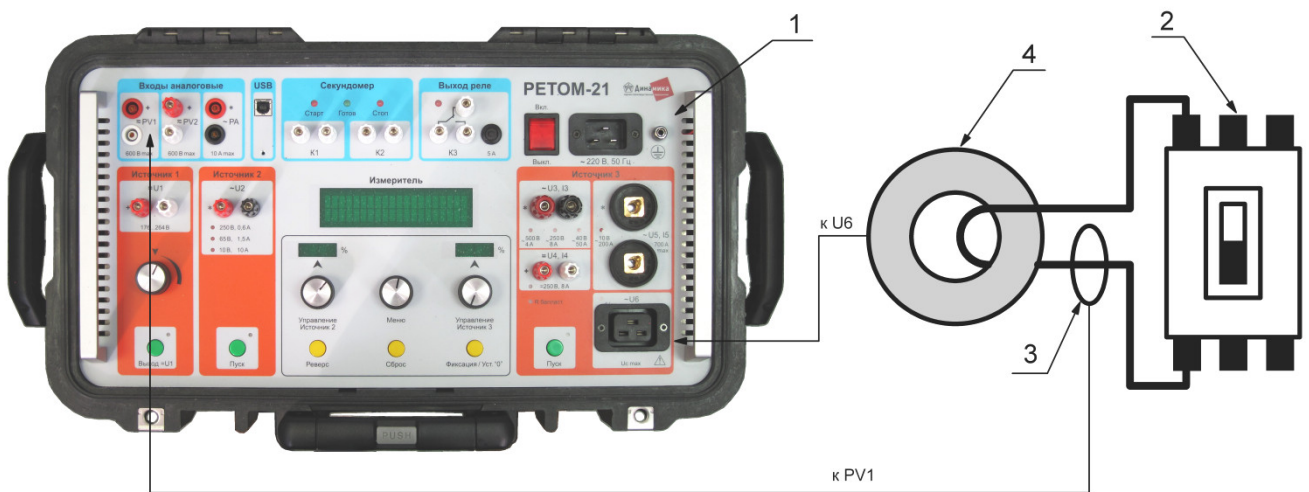
Рисунок 14.15 – Проверка выключателей с помощью PETOM-21 и PET-3000 в режиме фиксации от измерителя PV1 (по току)
