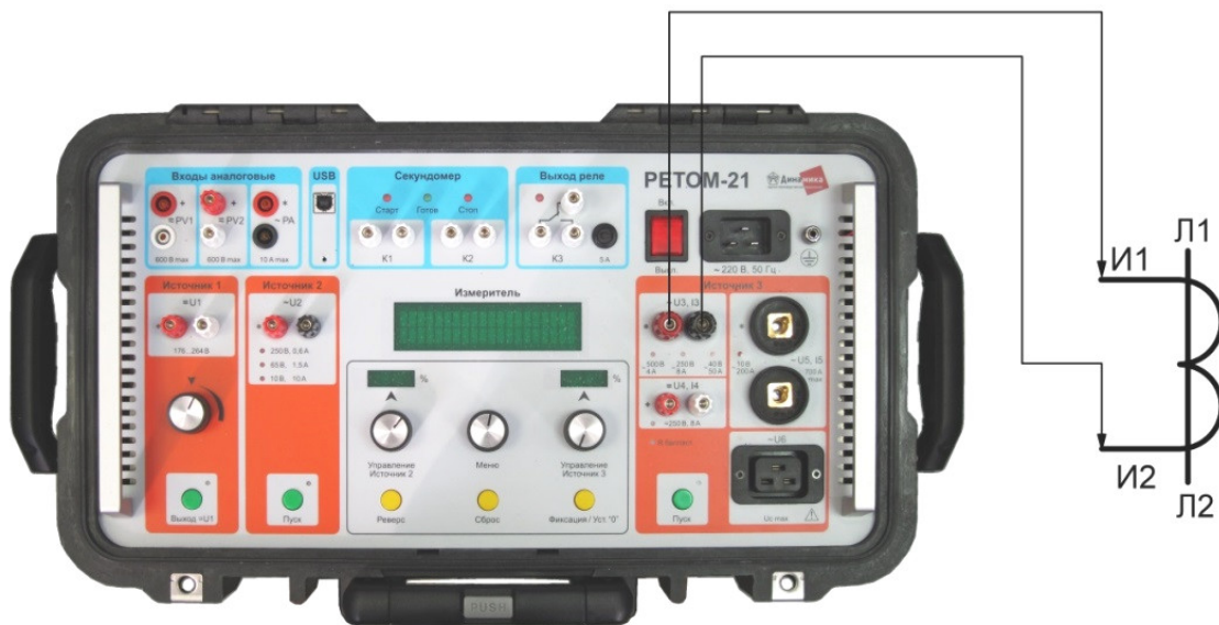
Рисунок 14.19 – Схема измерения характеристики намагничивания ТТ
