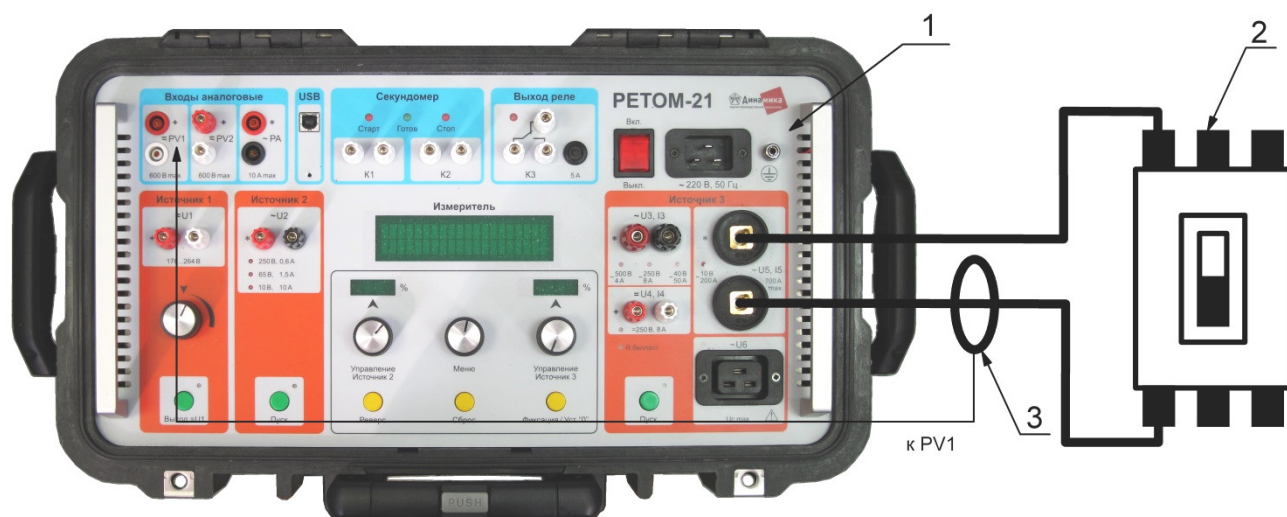
Рисунок 14.13 – Проверка выключателей с помощью РЕТОМ-21 в режиме фиксации по току от измерителя PV1
