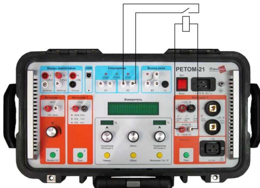
Рисунок 14.2 – Схема подключения промежуточного реле
