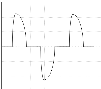
Рисунок 7.6 – Кривая потребления тока нелинейной нагрузки
