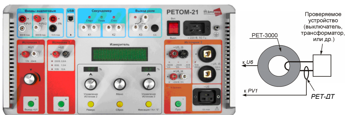
Рисунок 11.3 – Схема проверки различного электрооборудования с помощью РЕТ-3000
