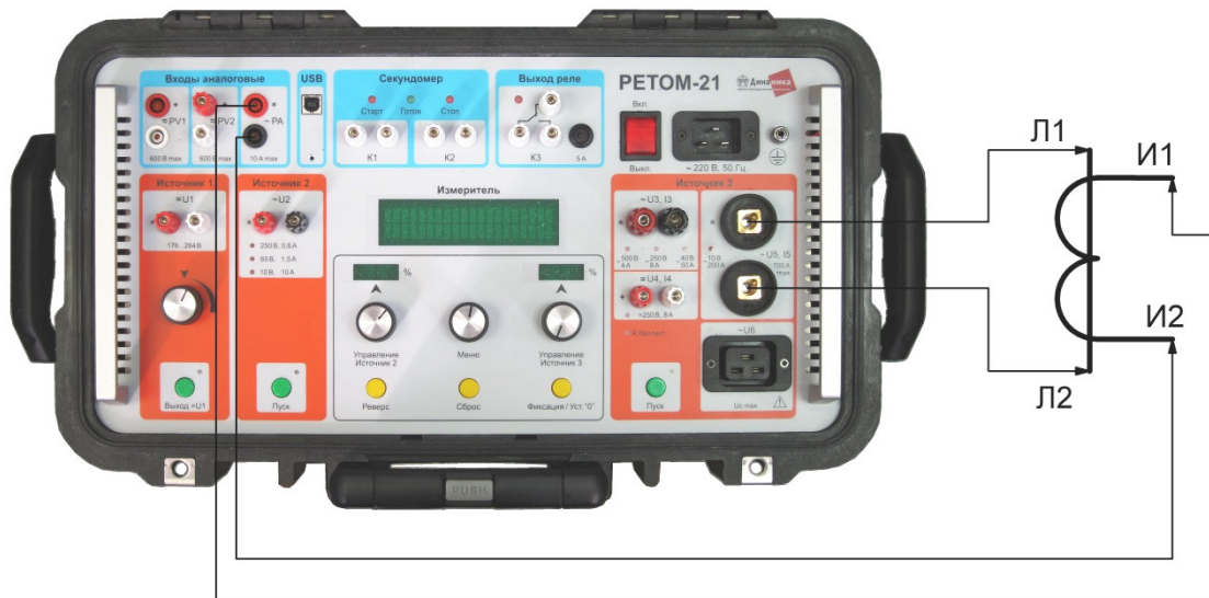
Рисунок 14.17 – Схема проверки полярности и коэффициента трансформации ТТ
