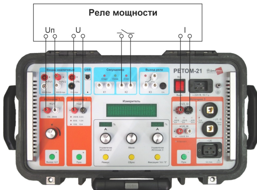
Рисунок 14.3 – Схема подключения реле мощности
