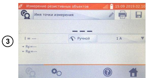
Переключение типа регулирования измерительного тока **Авто/Ручной**
