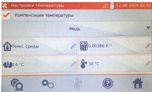
При включении температурной компенсации необходимо ввести все значения (поля, отмеченные красной рамкой обязательны для заполнения), для перехода к экрану измерения.
