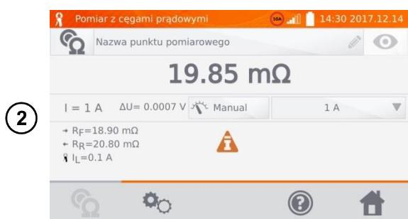
Кроме сопротивления, измеритель также отображает значение тока, измеренного клещами.
