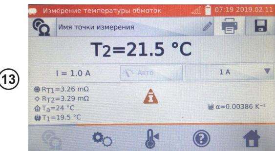
По истечении времени работы выключите электродвигатель и подключите измеритель к обмотке двигателя.
