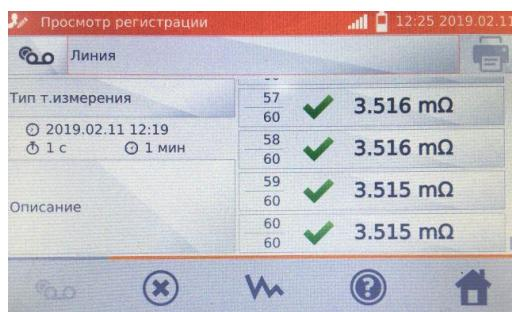
В случае **Регистрации**, нажатие поля с результатом вызовет отображение отдельных измерений с возможностью их прокрутки с помощью кнопок
