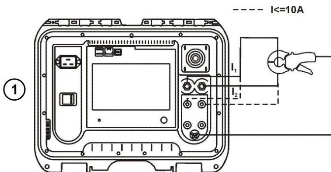
Необходимо замкнуть между собой оба токовых гнезда, охватить клеммами этот провод и нажать кнопку **СТАРТ/СТОП**. При калибровке клемм ток всегда меньше 10 А, поэтому можно использовать гнёзда 10 А или 100 А (200 А).
