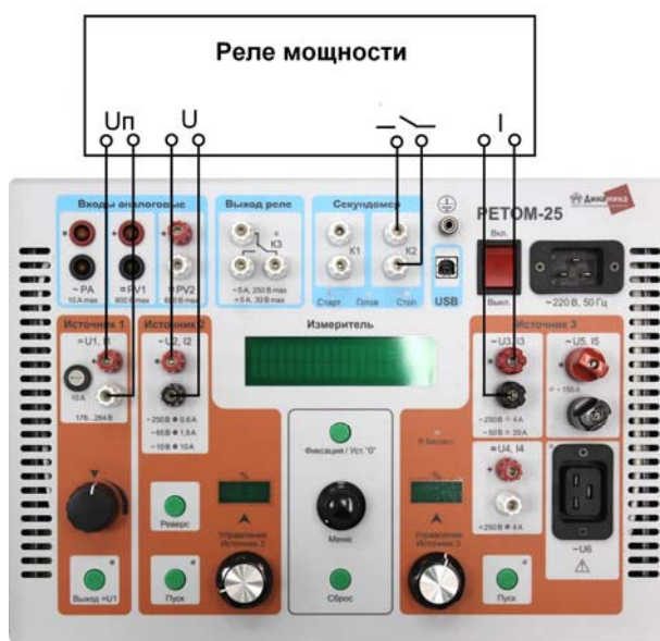
Рисунок 13.3 – Схема подключения реле мощности
