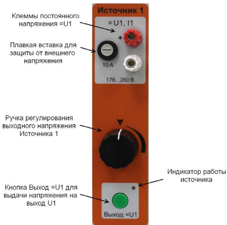
Рисунок 9.1 – Функциональные элементы Источника 1
