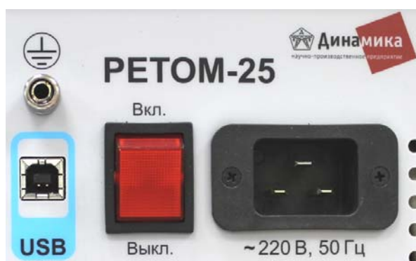
Рисунок 5.1 – Сетевой разъем, выключатель «Сеть», клемма защитного заземления и разъем USB тип В
