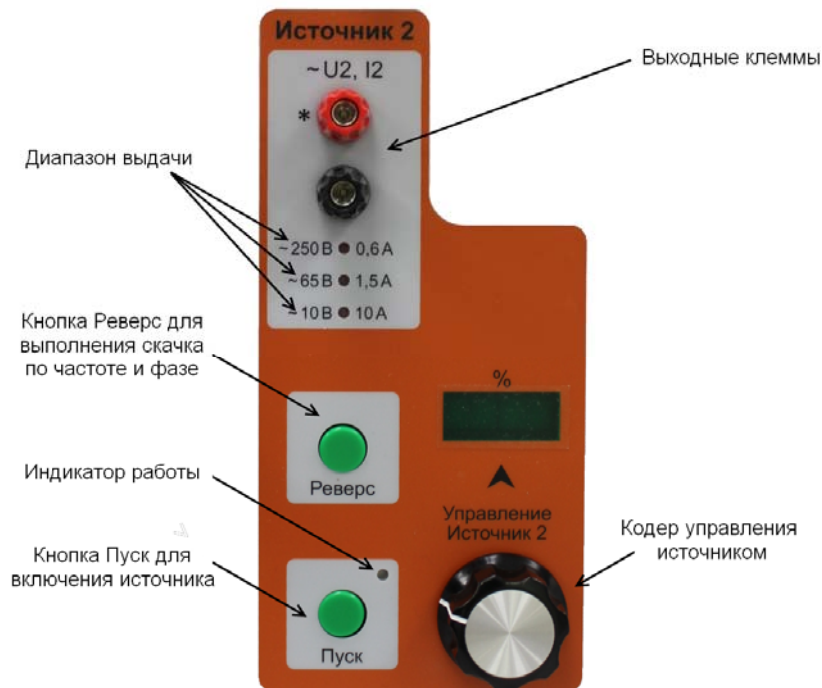
Рисунок 10.1 – Функциональные элементы Источника 2
