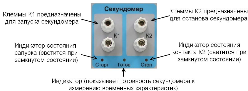
Рисунок 8.1 – Функциональные элементы секундомера
