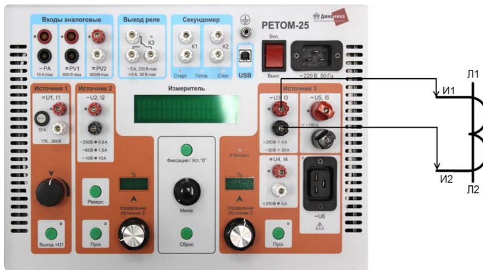
Рисунок 13.19 – Схема измерения характеристики намагничивания ТТ
