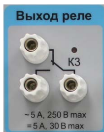
Рисунок 12.4 – Функциональные элементы выходного реле
