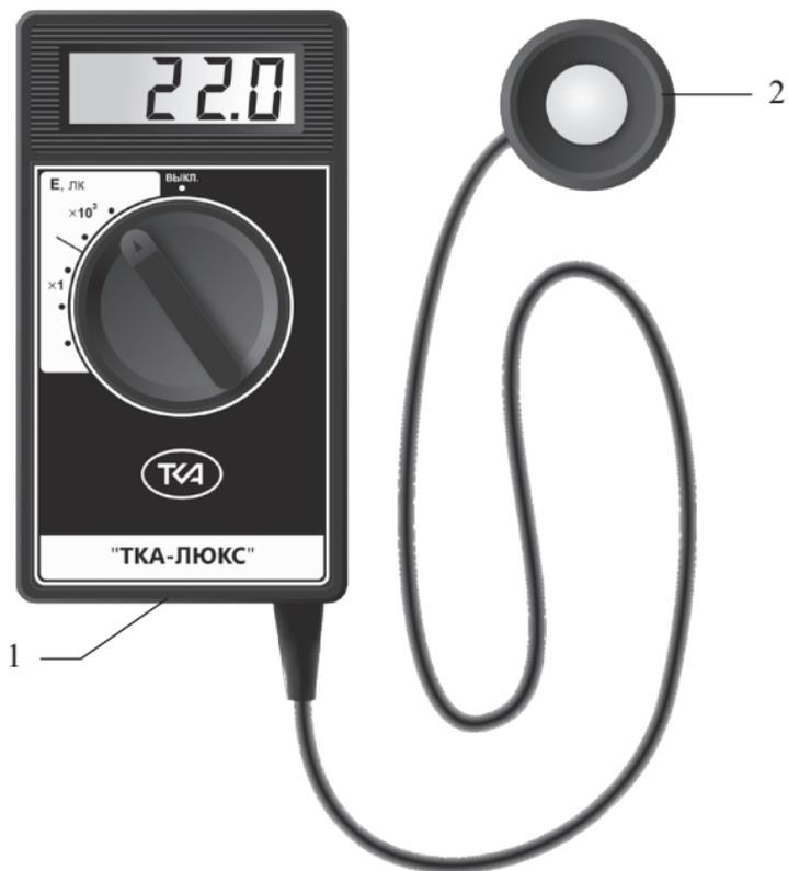
Рис.1 Внешний вид прибора “ТКА-Люкс”
