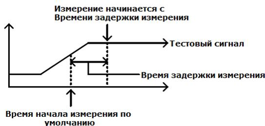
Установка задержки измерения полезна для измерения компонентов, которые требуют некоторого времени для зарядки, если время начала по умолчанию не является соответствующим. Соответствующее время задержки позволяет прибору избегать эффектов переходных помех, которые обычно наблюдаются при измерении реактивных испытуемых с источником тока.
