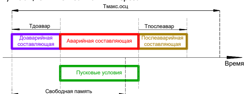
Рисунок 34 – Случай потери осциллограммы при значении настройки «Общие»–«Реж.записи»=«Останов.»
