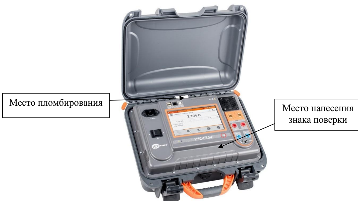
Рисунок 2 – Общий вид микроомметров модификации ТМС-6500, место нанесения знака поверки и место пломбирования
